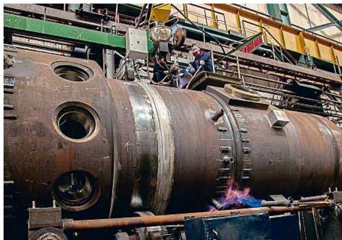
Jak se dělá reaktor Výroba reaktoru RITM-200 (kompaktnější následník KLT-40) ukazuje velikost malých reaktorů. 3x foto: Atomenergomaš
