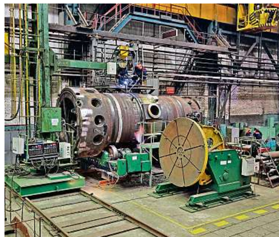
Jak se dělá reaktor Výroba reaktoru RITM-200 (kompaktnější následník KLT-40) ukazuje velikost malých reaktorů. 3x foto: Atomenergomaš
